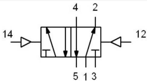
Válvula 5/2 pilotada por presión.
