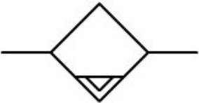
**Drenador de condensado, vaciado automático.**
