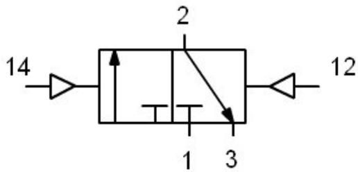
Válvula 3/2 pilotada por presión.
