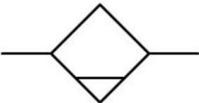
**Drenador de condensado, vaciado manual.**
