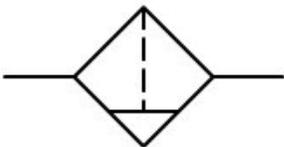
**Filtro con drenador de condensado, vaciado manual.**
