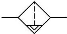
**Filtro con drenador de condensado, vaciado automático.**
